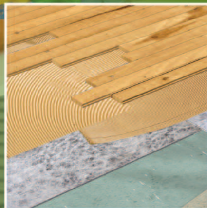
PLANCHER DE BOIS INSTALLÉ AVEC PRO 9000™ ET PRO CBM™ 2 SUR SUBSTRAT DE BÉTON APPRÊTÉ AVEC PRO SUPERPRIME™
