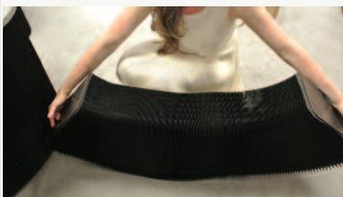
Un matériau en polyéthylène non tissé, aussi nommé Tyvek, 100 % recyclable et ayant de 5 à 15 % de contenu recyclé. Malgré son aspect de papier à l'œil et au toucher, il résiste aux déchirures, aux rayons UV et à l'humidité, ce qui facilite sa manipulation et son entretien et le rend extrêmement durable.
